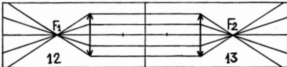
Figure 13 : les rayons que la lentille reçoit parallèles à l'axe optique sont tous dirigés en un point  $F_2$  où ils se croisent en aval de la lentille convergente, puis continuent en un faisceau ouvert.
