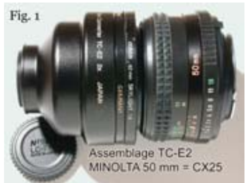
Fig. 1 : assemblage TC-E2 + Minolta = CX25
