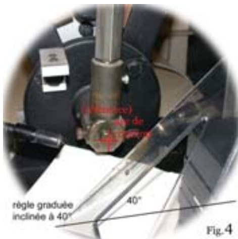
Fig 4 : règle graduée inclinée à 40^\circ
