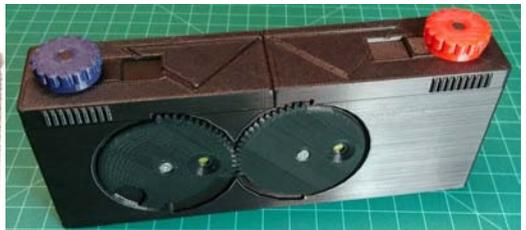
Une imprimante 3D n'est bien sûr pas capable de produire les sténopés eux-mêmes (une fine plaque métallique percée d'un trou régulier de 0,3 mm environ), il faudra les réaliser soi-même ou trouver un vendeur qui en propose.
