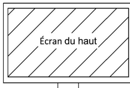
L'image de l'écran du haut est réfléchi par le miroir, donc inversée gauche-droite. L'axe de polarisation est également inversé.
