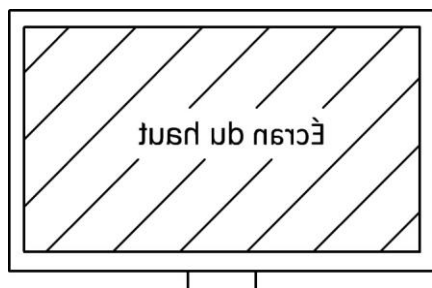
L'image de l'écran du haut est réfléchi par le miroir, donc inversée gauche-droite. L'axe de polarisation est également inversé.
