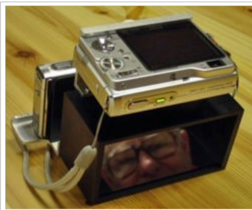
Double Sony W-90 Ekeren avec système macro à miroir semi-transparent. Dans la boîte, Edmond Bonan.
