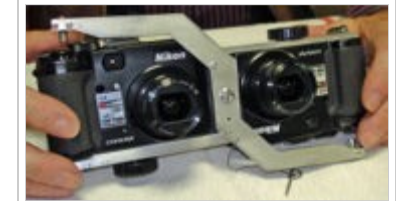
Synchronisation mécanique de deux compacts Nikon CoolPix P6000, réalisée par Roger Huet.
