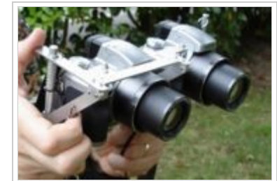
Synchronisation mécanique réalisée par Roger Huet, ici sur les bridges Sony de Gilbert Grillot
