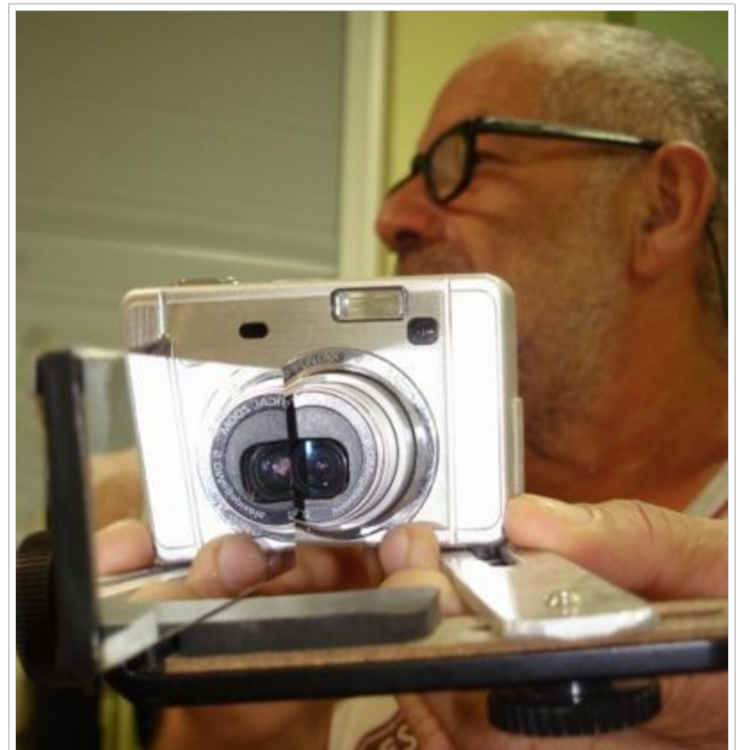
Sylvain Weiller : la macro à un seul miroir (nécessite un objectif photo de petit diamètre pour obtenir une base de ~5mm !)
