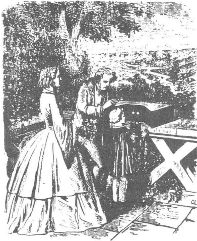
FIG. 3. Forme extérieure du téléstéréoscope.
