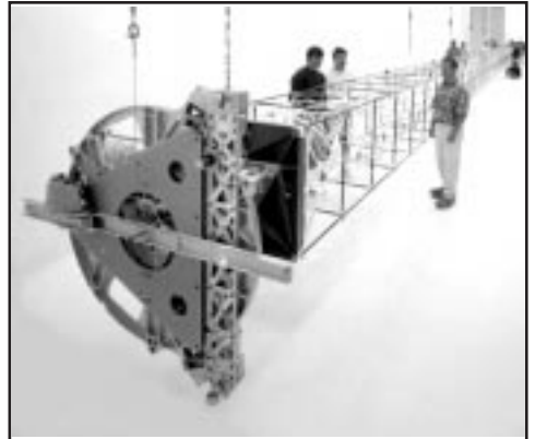
Le mât télescopique de 60 mètres, au cœur de la mission SRTM.
