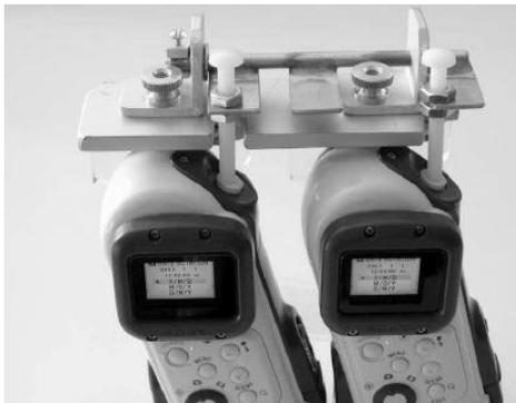
Fig. 1 : Couplage mécanique de deux boîtiers numériques.
