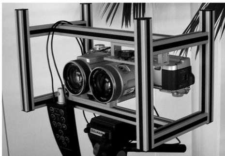
Fig. 7 : Ensemble "Ste-fra CAM" de deux boîtiers à base ajustable.
