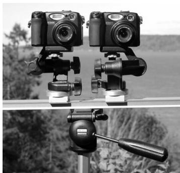
Fig. 8 : Deux appareils couplés par Harbortronics.
