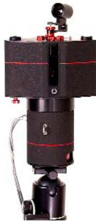
utilisée – de 700 mm à plus de 2 000 m pour des rotations de 360° (cas des Cirkut Kodak). Les principes de fonctionnement des appareils rotatifs sont d'une très grande simplicité et permettent toutes les combinaisons entre chambres et optiques. L'axe de rotation de l'ensemble correspond au point nodal de l'objectif ; le cercle de l'image autour du point nodal a pour rayon la longueur focale de l'objectif et le format de l'image pour 360° est donc égal à  $2 \times \pi \times f$ .
