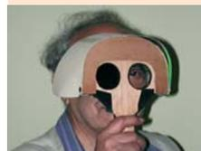
Michel Melik et sa visionneuse Pulfrich à filtre réglable (double polarisant rotatif) et à bascule instantanée.
