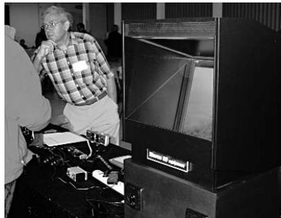
■ La Cobox de Jacob van Ekeren (ci-dessus) est constituée de deux écrans LCD 17 ou 19 pouces et d'un miroir semi-transparent. Le système exploite la polarisation naturelle des écrans. Une simple paire de lunettes polarisantes classique suffit alors pour observer une belle image lumineuse et bien définie. Contrairement aux systèmes à réseaux, la position d'observation n'est pas imposée et son utilisation en est plus agréable.
