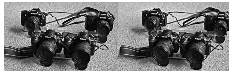
À l'arrière : les anciens reflex F90X argentiques sur une grande barre (base = 35 cm). Devant : les nouveaux reflex D200 numériques côte à côte sur la plus petite barre (base = 15,5 cm). En couverture : les mêmes avec zooms déployés. Les pare-soleil sont utiles en grand-angle.
