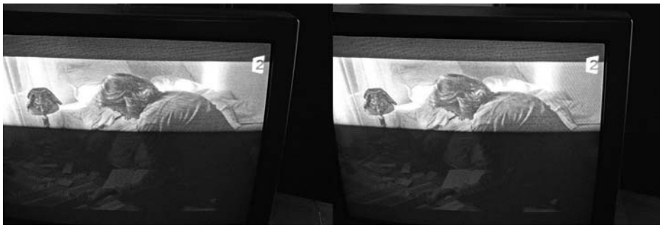
Test de synchronisation : un écran de télévision au 1/125 de seconde, base = 15 cm. Info Exif : ouverture f/3,5, sensibilité = 1600 ISO, focale = 28 mm.
