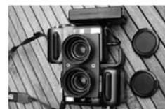
↑ 13 - Deux APN Sony DSC S85 couplés pour prise de vue relief, écart. 65 mm, commandés par dispositif électronique de ma fabrication avec les fonctions: on/off, zoom AV et zoom AR en continu, déclenchement. Prise de vue verticale (rapport 3/4). Accus, mémoires, 4,1 Mpix, zoom Vario Sonnar 2/7-21 (équiv. 35-100). Donne 3° appareil fonctionnel. Me contacter pour plus de renseignements. 350€ + port.
