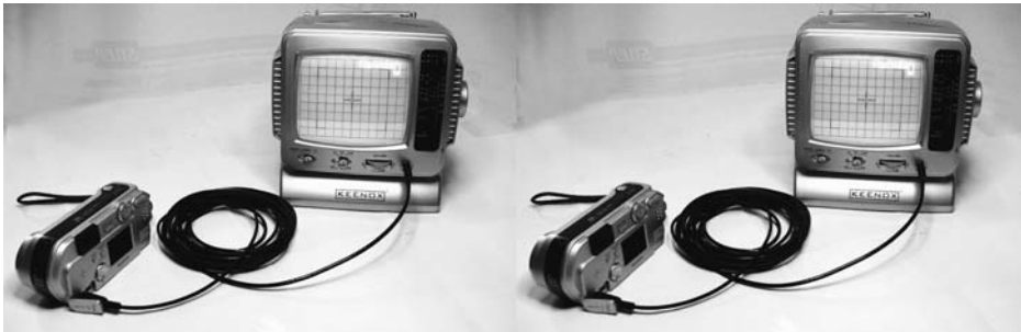
APN relié à la prise jack de la face avant d'un téléviseur bon marché, muni d'un réticule fait maison.
