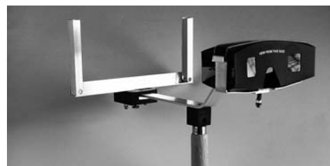
Visionneuse « Holmes-Loreo », cinquième évolution. Ce stéréoscope pour vues sur papier 10 x 15 collées sur carton 9 x 18 (type Keystone ou SIP) est entièrement pliant, très pratique à transporter.
