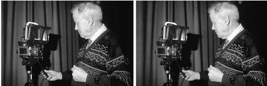
Roger Pochet en 2000 devant son caméscope à prismes diviseurs placés devant l'objectif et à prismes « fusionneurs » placés devant le grand viseur stéréoscopique (photo P.P.).
