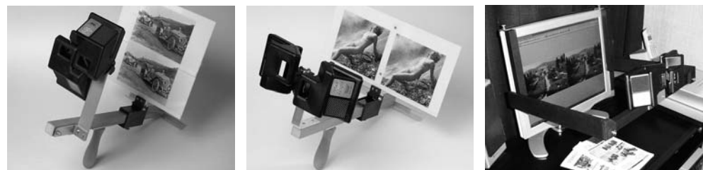
Visionneuses construites autour du View-Magic, stéréoscope à 4 miroirs pour vues de grandes dimensions: vues dessus-dessous ou côte à côte sur papier et sur écran d'ordinateur. La fabrication des View-Magic est malheureusement interrompue, mais on en trouve encore en vente sur le site berezin.com
