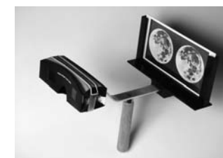
Visionneuse « Holmes-Loreo » ou comment recréer un classique du XIX e siècle sur la base de moderne lorgnon Loreo à lentilles prismatiques (en vente 2 € au Club, voir Charles Clerc). Ce premier essai, en alu, plastique et bois, n'était pas pliant. Ci-dessous, le dernier modèle.
