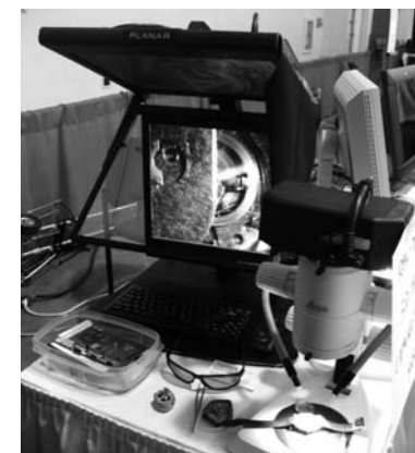
SD&A 2006. Micro Vision Systems affiche en « live » l'image issue d'un microscope stéréo sur un double écran Planar à miroir semi-transparent.
