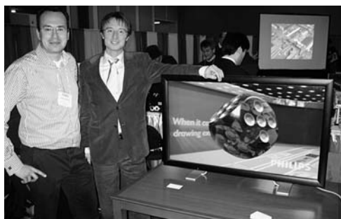
Écran LCD lenticulaire de 42" à 9 vues montré par les représentants de Philips à la conférence SD&A 2006. Les écrans autostéréoscopiques de Philips sont très novateurs : leur réseau lenticulaire est « escamotable » (comme les barrières de Sharp !), permettant un usage 2D ou 3D de l'écran. Cela grâce à des lentilles remplies de cristaux liquides, qui changent d'indice de réfraction suivant qu'une tension leur est appliquée ou non !
