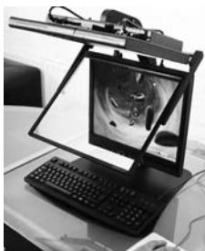
Double écran Planar à semi-transparent StereoMirror SD1710, 17 pouces, 1280x1024, vendu en France par Dynamic Trading (Paris), 3 395 € HT. www.dynamic-trading.eu . Voir aussi Trivision3D.
