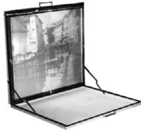
L'écran Scoplex en possession du SCF. Logé dans une valise de transport en bois, ce réseau lenticulaire de 60 cm a sa face plane recouverte de peinture métallisée et s'utilise par réflexion. Le projecteur, avec des objectifs écartés de 6 cm, doit être placé à 6 m de l'écran. Les spectateurs sont au nombre de six au maximum. (Photo Roland Duchesne.)
