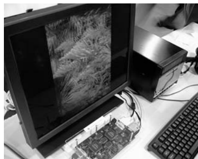
SD&A 2006. L'écran stéréoscopique Photonics 19" de Polar Screen fonctionne sur le principe « 3ality » à double couche LCD. Il est donc en pleines couleurs, pleine définition, affichage permanent, et ne nécessite que des lunettes polarisantes passives.
