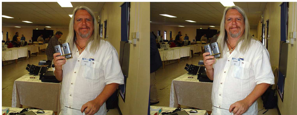
Couplage de deux téléphones portables (1,3 Mpix) sur un support en laiton par Ken Burgess (USA). Le logiciel écrit par Ken permet aux deux smartphones de dialoguer par liaison sans fil Bluetooth pour synchroniser le déclenchement et les zooms. C'est le 1 er prix du concours d'équipement du congrès ISU d'Eastbourne en 2005. Cliché P. Meindre, bulletin n°892, décembre 2005.
