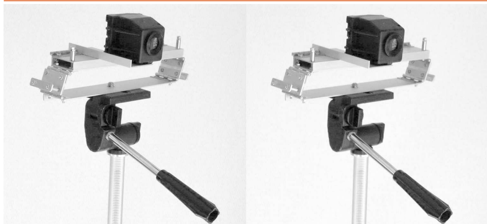
Réglette à bascule articulée pour la proxi et macrostéréo de M. Couchot, bulletin n°887, mars 2005
