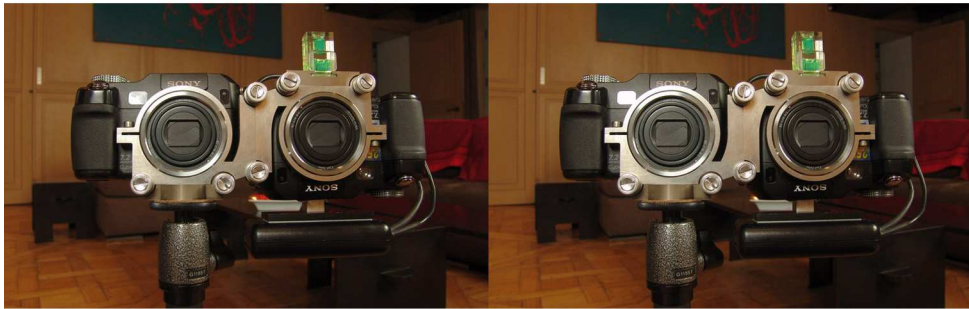
Couplage de deux Sony V3 par M. Alard, ce système particulièrement sophistiqué associe un contrôle de synchronisation « LANC Shepherd » à un bâti en titane qui permet de passer très simplement du cadrage horizontal au cadrage vertical. Bulletin n°892, décembre 2005.
