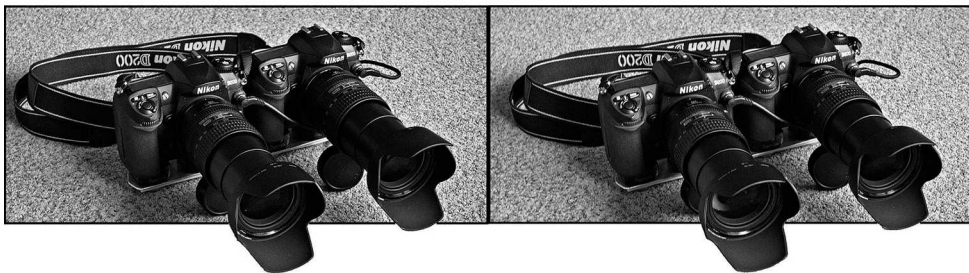
Couplage de deux Nikon D200 avec synchronisation électrique par P. Gidon, les appareils peuvent être radiocommandés, bulletin n°897, août-septembre 2006
