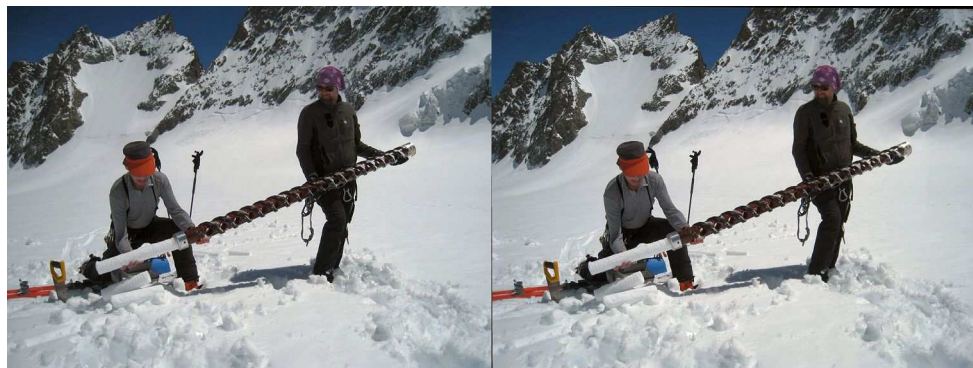
Récupération et mesure des carottes de neige - Photo : Mireille Coulon
