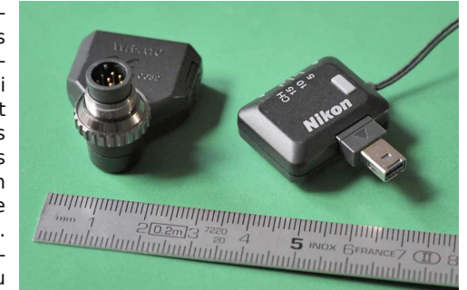
À gauche l'adaptateur WR-A10 pour raccorder l'émetteur-récepteur à la prise 10 broches du D500. À droite l'émetteur-récepteur WR-R10.
