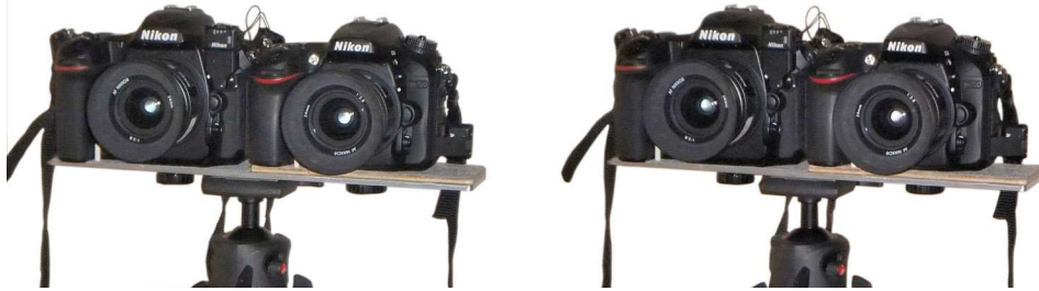
Les deux boîtiers sur leur support avec leurs émetteurs-récepteurs respectifs. Le D500 est sur la gauche et le D7200 à droite, sur la photo, les boîtiers sont équipés de 24mm ce qui donne un équivalent 36 mm en 24x36. - Photo : Thierry Mercier
