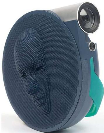
• La caméra **Oren Geva 2C3D** est une « vraie » caméra 3D mais destinée aux aveugles avec un « écran » 3D tactile basé sur le principe des jouets de type *Pin Art*. L'appareil capture la scène en relief et la reconstitue sur l'écran. Il s'agit d'un prototype de la société israélienne *Oren Geva* qui a reçu le prix du concours *Asia Design Price 2018*.
