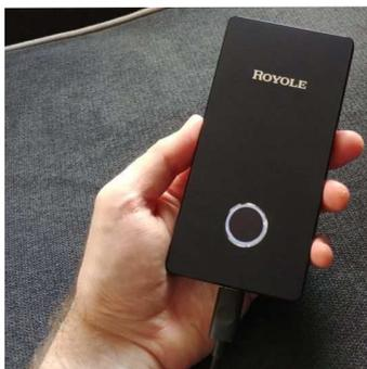
à +2, l'arceau se replie après usage pour plus de compacité. Le casque est autonome, relié seulement à un petit boîtier comprenant la batterie (environ 5 heures d'autonomie), une mémoire de 32 Go pour y stocker ses vidéos et la connectique, HDMI notamment et Wifi et Bluetooth pour le sans-fil.
