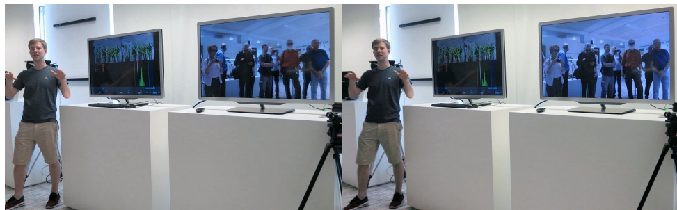
Démonstration du logiciel "Stan" (Stereoscopic Analyser) au 3IT. Les visiteurs sont filmés par la double caméra (tout à droite), le logiciel aligne, corrige et affiche les disparités stéréoscopiques en temps réel sur l'écran de gauche et diffuse la vidéo 3D corrigée sur l'écran de droite - Photo : Pierre Meindre
