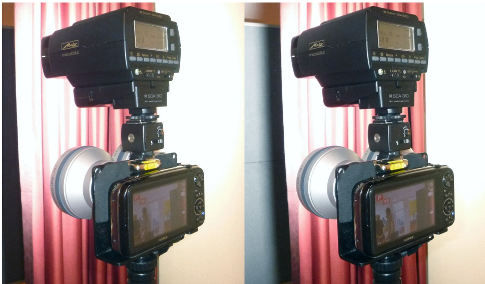
Un Fuji W3 monté dans le berceau adaptateur de Rafal Michalowicz avec des optiques complémentaires et un gros flash externe - Photo : Pierre Meindre
