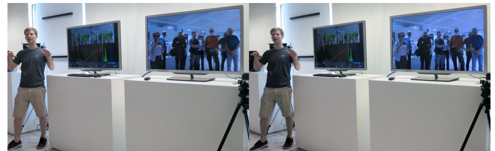
Démonstration du logiciel "Stan" (Stereoscopic Analyser) au 3IT. Les visiteurs sont filmés par la double caméra (tout à droite), le logiciel aligne, corrige et affiche les disparités stéréoscopiques en temps réel sur l'écran de gauche et diffuse la vidéo 3D corrigée sur l'écran de droite - Photo : Pierre Meindre
