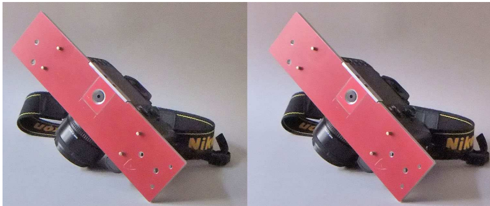
Plaque de couplage avec les chevilles de calage et la vis au pas Kodak pour fixer le boîtier - Photo : Thierry Mercier
