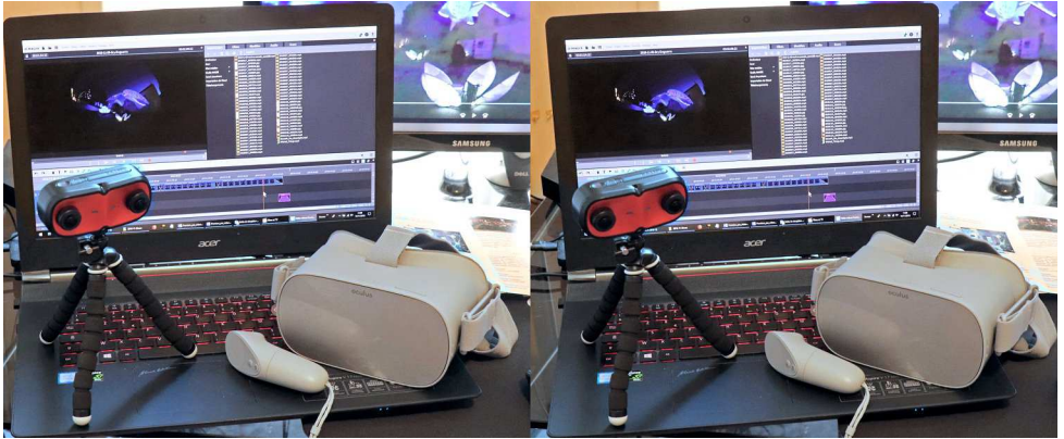
Prise de vues 3D, traitement sur ordinateur et visualisation avec la Caméra « AntVR », un PC avec le logiciel « Magix Vidéo » et le casque « Oculus Go » - Photo : François Lagarde
