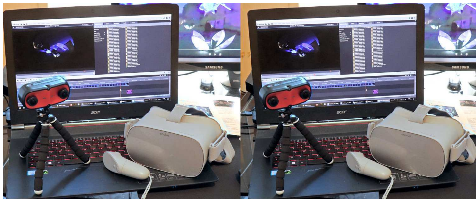
Prise de vues 3D, traitement sur ordinateur et visualisation avec la Caméra « AntVR », un PC avec le logiciel « Magix Vidéo » et le casque « Oculus Go » - Photo : François Lagarde
