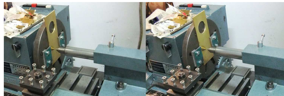
Travail de la plaque porte-objectif sur un tour - Photos : Alexandre Buchmann
