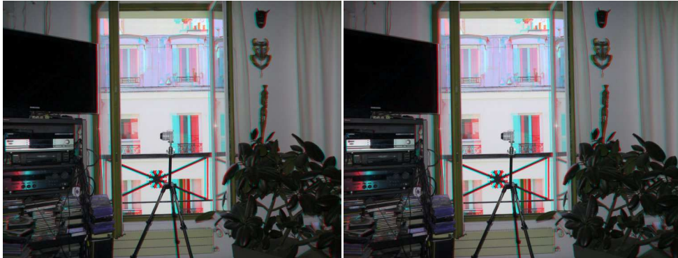
Photos prises avec un Panasonic GX1 + objectif 28 mm monté sur une réglette. Base 6 cm, le "sujet" sur lequel la convergence a été faite se trouve à 2 mètres de distance, donc un angle de convergence d'environ 2°. Les deux couples ont été alignés dans StereoPhoto Maker (qui a corrigé les déformations trapézoïdales dues à la convergence) puis la fenêtre a été positionnée sur le sujet, comme en convergence.
