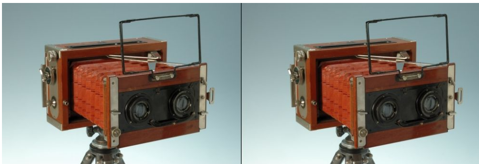
CONTESSA NETTEL, Allemagne, 1920, obturateur à rideau vertical : instantané, poses B et T, objectifs Tessar Zeiss FA5 90 mm f: 6 à 32, mise au point par allongement du soufflet en cuir, décentrement vertical, format 6 x 13 cm ou panoramique sur châssis, dos pour film 120.
