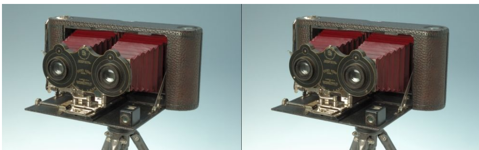
MACKENSTEIN, France, modèle Francia , n°8482, format 6 x 13 cm, objectifs Dagor 111, soufflet cuir, adaptateur amovible pour film 120 et vues panoramiques.
