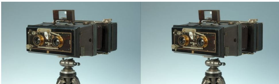
EASTMAN KODAK, USA, modèle Stereo Kodak n° 1 , 1920, base 82,5 mm, objectifs anastigmat 130 mm, f: 7,7 à 45, obturateur : poses B et T, 1/25s, 1/50s, 1/100s, format 2 x 78 x 80 mm sur film 101, boîtier en bois gainé.
