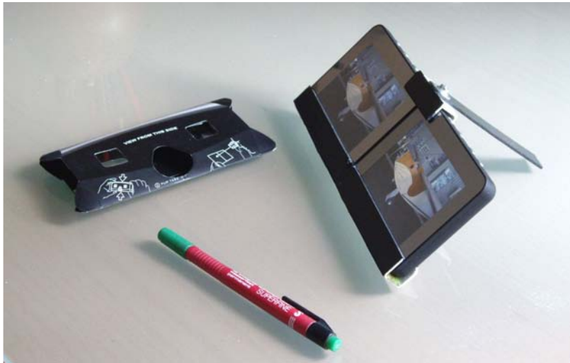
Photo 1 (ci-dessus) : le stéréoscope de poche sur sa béquille, à gauche le "fusionneur" Loreo Lite 3D Viewer.
