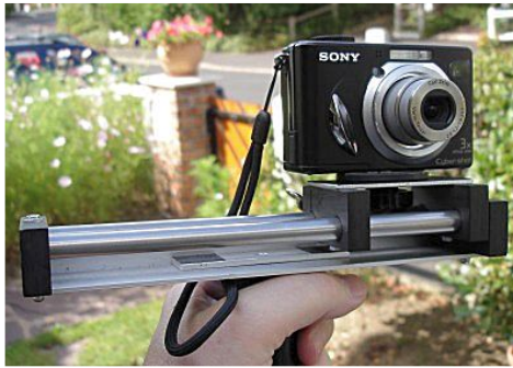
Prise de vue en deux temps sur glissière et pied-colonne de poche
