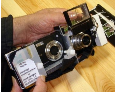
Deux compacts Pentax synchronisés par infrarouge (Michel Melik)
