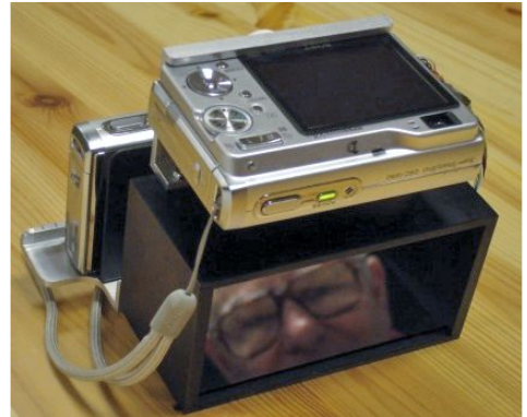
Double Sony W-90 Van Ekeren avec système macro à miroir semi-transparent. Dans la boîte, c'est Edmond Bonan, qui vous salue bien.
