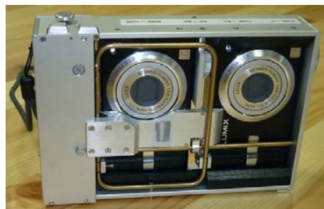
Synchronisation mécanique réalisée par Charles Couland : l'arceau jaune est la commande des zooms. Au milieu de la plaque centrale, sortie commune des deux flashes.
