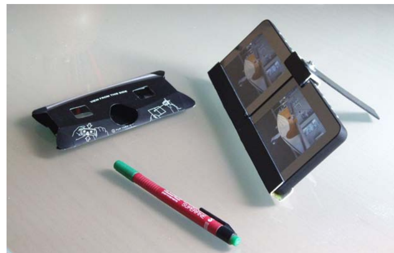
Photo 1 (ci-dessus) : le stéréoscope de poche sur sa béquille, à gauche le "fusionneur" Loreo Lite 3D Viewer.
