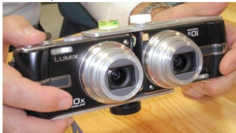
Double TZ-3 couplé par Van Ekeren
