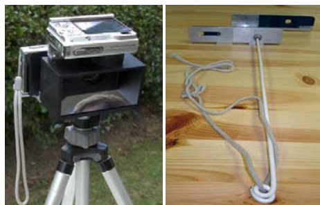
Le double Sony W90 macro dans la verdoyante nature, prêt à l'emploi L'astucieux pied de poitrine d'Olivier : une cordelette à passer autour du cou et un morceau de cintre
