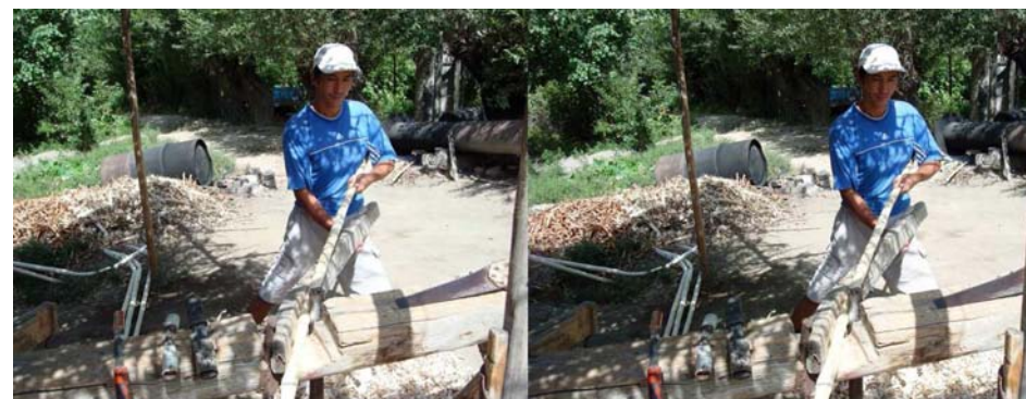
Fabrication des yourtes (torsion d'une pièce de bois : le youlouk), Kirghizistan Photo : Daniel Courvoisier
