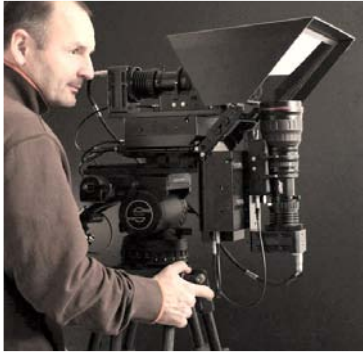
Caméra numérique stéréo à miroir semi-transparent de la société Binocle Photo : site web Binocle
