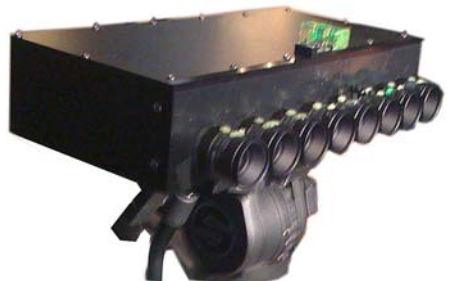
Une caméra numérique à 8 objectifs destinée l'enregistrement d'objets pour des publicités en relief sur écran Alioscopy - Photo : Pierre Gidon
