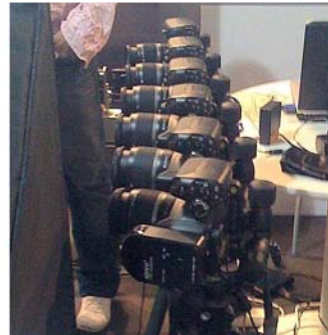
Série d'appareils synchronisés pour la photographie lenticulaire instantanée de la société Holoimage Photo : Pierre Gidon
