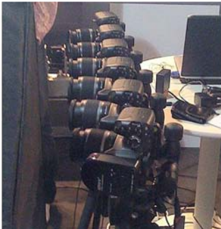
Série d'appareils synchronisés pour la photographie lenticulaire instantanée de la société Holoimage Photo : Pierre Gidon
