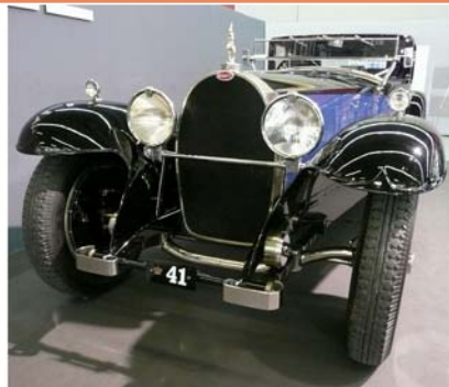
Bugatti 41 "Royale" - 8 cylindres en ligne, 12,7 l de cylindrée, 205 km/h et des jantes de 24" pour ce monstre produit en six exemplaires, en 1928. La "Bugatti du Patron" est exposée au musée de l'Automobile de Mulhouse. - Photo : Gérard Métron
