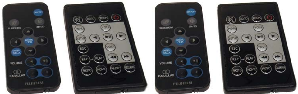
Les mini télécommandes des deux appareils (Fuji à gauche, Inlife à droite) Elles font moins de 90 mm de haut et pèsent une vingtaine de grammes.
