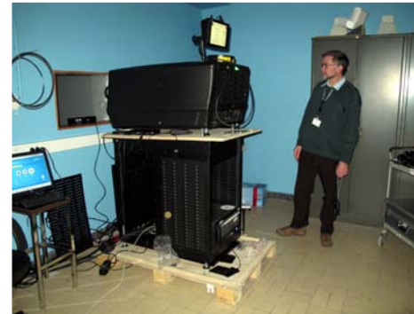
La régie de projection de la petite salle. Benoît Michel se tient derrière le projecteur Barco DP 2000. En bas du projecteur, se tient le serveur Dorémi qui alimente en images le projecteur. Le contrôle du projecteur se fait à partir de la régie principale de la grande salle. Sur le bord de la fenêtre de projection on distingue l'émetteur infrarouge principal qui sera relayé par trois autres émetteurs et récepteurs disposés sur scène en bas de l'écran de projection.
