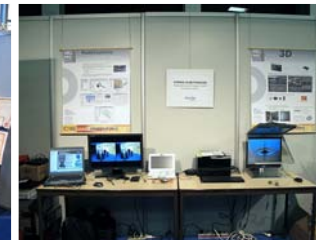
Le stand du Stéréo-Club Français. À gauche, le moniteur 3D Zalman 22" à lunettes à polarisation circulaire et à droite le moniteur 3D à miroir semi transparent à lunettes à polarisation linéaire.
