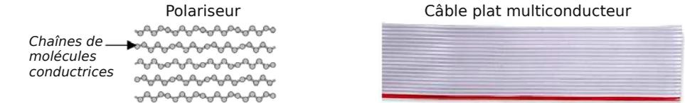
**Fig 1.** Dans un polariseur les chaînes de molécules sont conductrices et isolées entre elles. Un polariseur peut donc s'apparenter à un classique câble plat multiconducteur.
