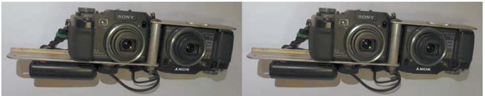
Deux appareils Sony DSC-V3 montés sur une Z-barre. L'objectif n'étant pas centré horizontalement dans le corps du boîtier, mettre un appareil la tête en bas permet de minimiser la base stéréoscopique : 90 mm ici au lieu de 125 mm s'ils étaient simplement placés côte à côte.
