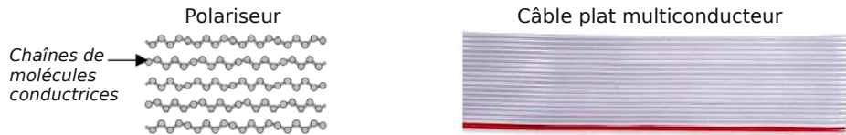
Fig 1. Dans un polariseur les chaînes de molécules sont conductrices et isolées entre elles. Un polariseur peut donc s'apparenter à un classique câble plat multiconducteur.
