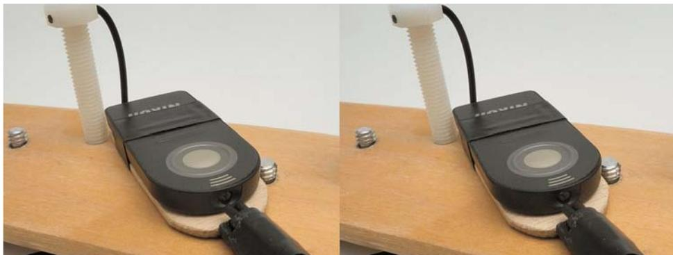
*La télécommande positionnée face aux deux fibres optiques - Photo : Jacques Sandillon*
