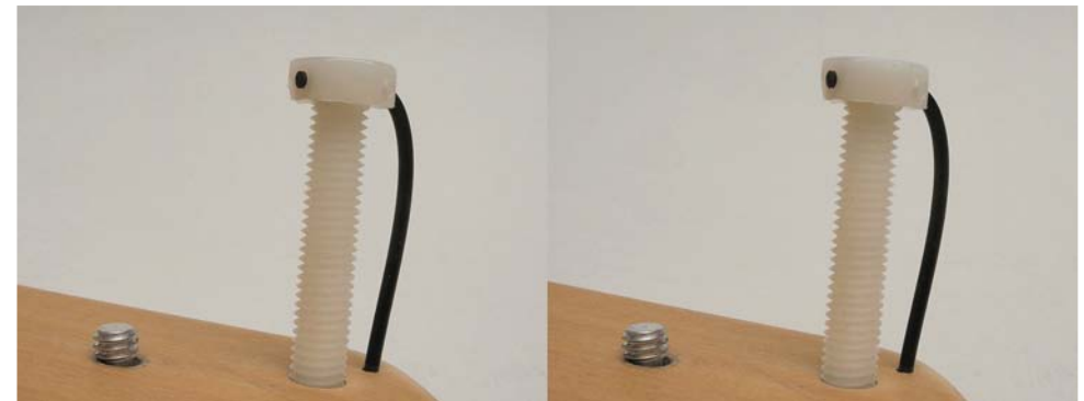
Détail de la vis servant à positionner l'extrémité de la fibre optique face au capteur infrarouge de l'appareil photo - Photo : Jacques Sandillon
