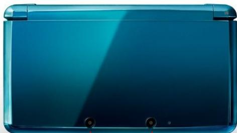
La console refermée. Les deux objectifs sont sur le capot supérieur, près du bord. La base stéréo est réduite et la qualité des images aussi.
