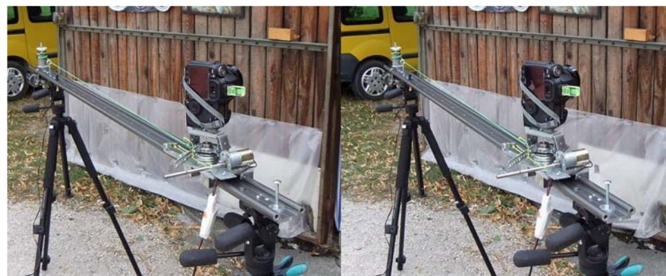
L'appareil photo en position initiale sur le "Bamako 8". On notera l'angle de l'appareil, sa rotation est contrôlée au cours du déplacement du chariot par le moteur visible au premier plan - Photo : Pascal Granger
