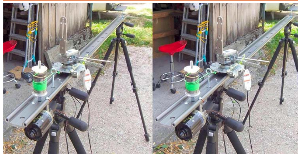
Détail de la poulie avec le fil de traction du chariot sur le "Bamako 8" - Photo : Pascal Granger
