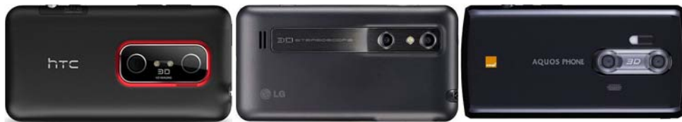
HTC Evo 3D Taille : 126 x 65.4 x 11.3 mm Base = 30 mm LG Optimus 3D P920 Taille : 128 x 68 x 11,9 mm Base = 24 mm Sharp Aquos Phone SH80F Taille : 127 x 64 x 11,6 mm Base = 28 mm
