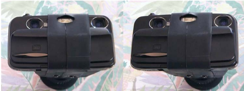
Vue de face avec l'échancrure pour le passage de l'éclair du flash
