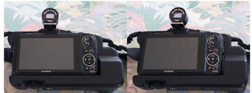
Viseur à champs « collimatés » de 35-85-135 (marque Hélios)
