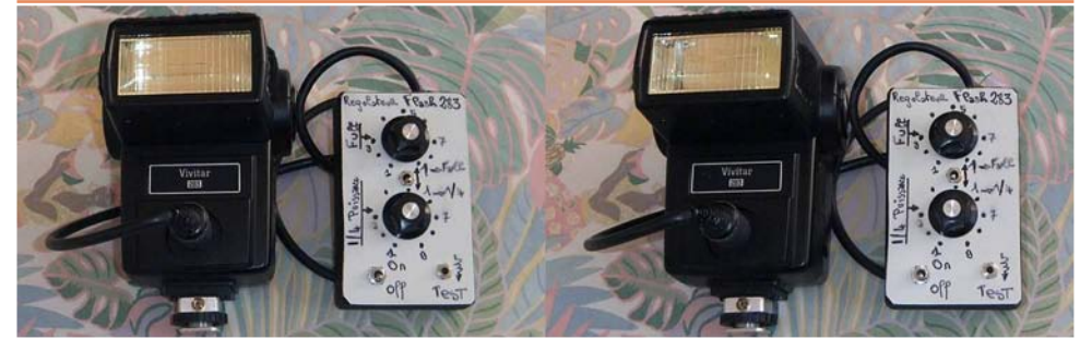
Seconde proposition de modification du flash Vivitar 283
