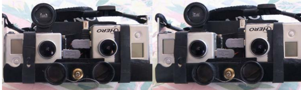
Caméras GoPro couplées pour vidéos 3D, base 65 mm, avec viseur Holga
