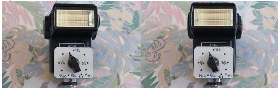
Potentiomètre de 250 K ohms en lieu et place du « Sensor » Vivitar
