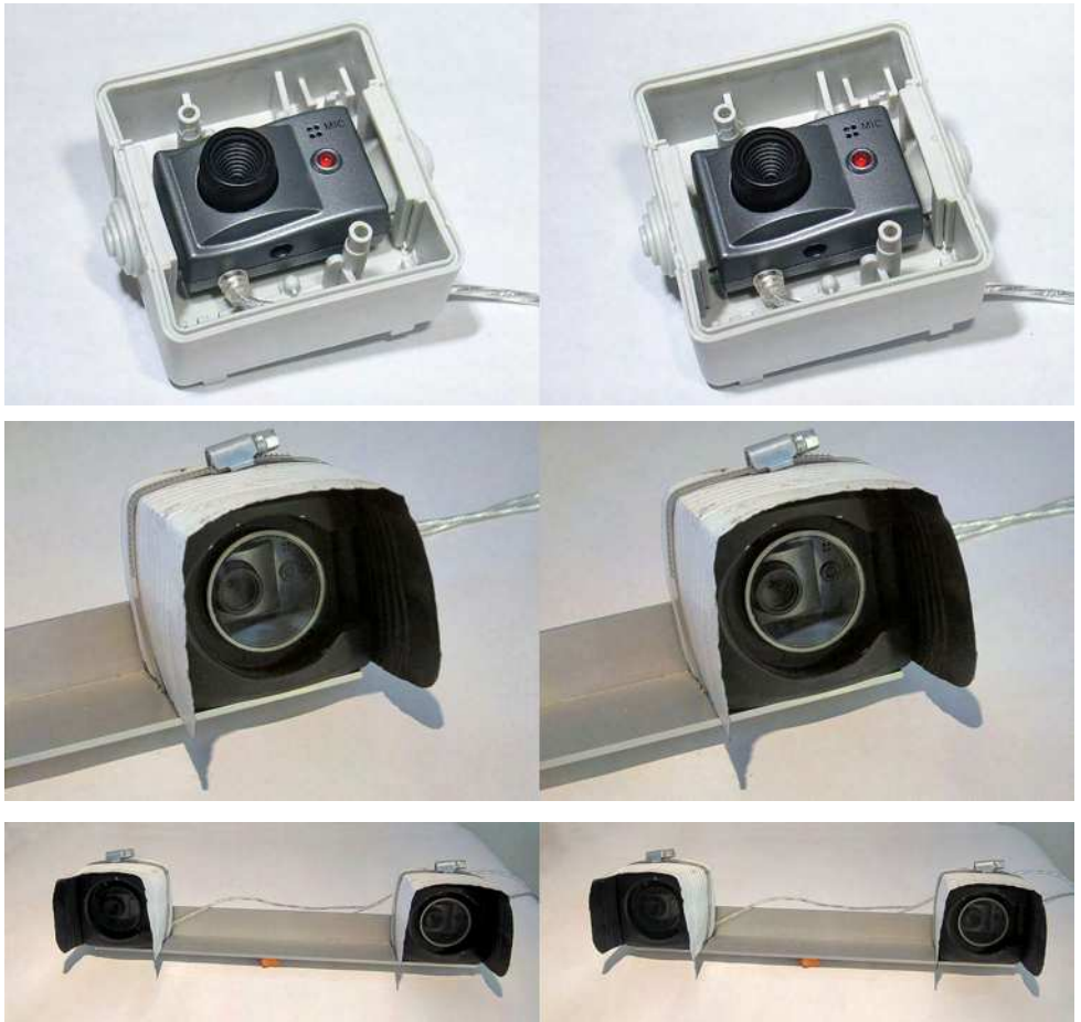
Étapes du bricolage d'une webcam hyperstéréo d'extérieur - Photos : Pierre Meindre
