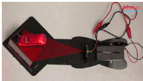
Le kit Litiholo vu de dessus (les rayons lumineux sont simulés), la plaque sensible est en bas à gauche.
