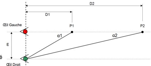
Si E est l'écart interpupillaire des yeux (65 mm), D1 la distance du premier plan (2 m), D2 la distance du deuxième plan (infini), on peut exprimer  $\alpha_1$ , l'angle de convergence de l'œil droit pour observer le point P1.
