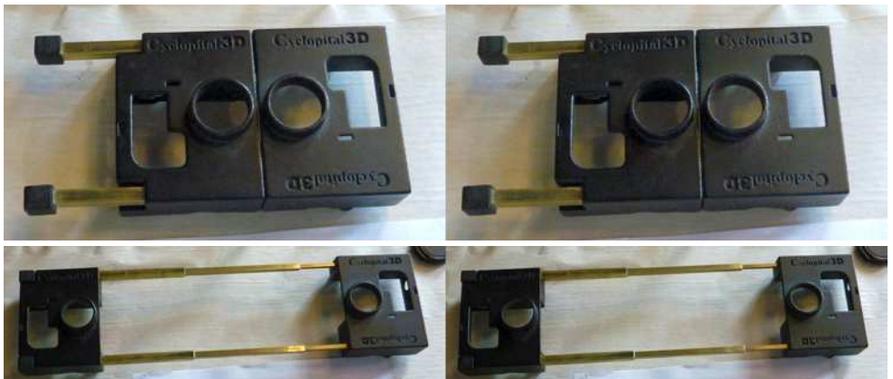
Prototype Cycloptical de monture à base ajustable pour deux caméras GoPro Photo : Pierre Meindre
