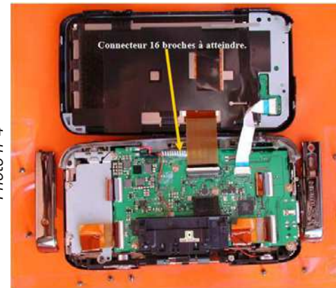
W3 ouvert : bien repérer les différentes vis (collage sur un adhésif double face)
