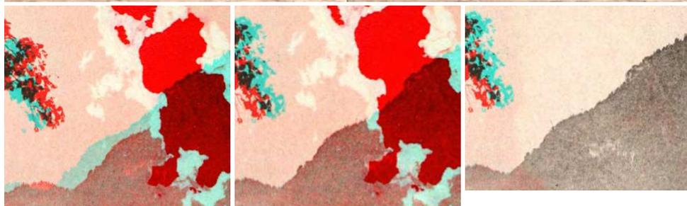
À gauche : une partie de la photo non retouchée en anaglyphes. Au centre : la même partie après décalage pour mettre en coïncidence la montagne boisée. À droite : la même après correction avec la brosse clone.
