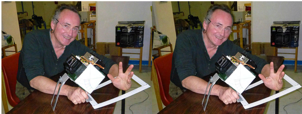
Bruno Lonchamp et son système de prise de vue macro-fantôgramme. Les deux appareils synchronisés par SDM sont montés sur une "boîte" munie d'un miroir semi-transparent. Le cadre blanc gradué est solidaire de la boîte (angle fixé à 45°) ce qui permet des cadrages et prises de vue faciles et rapides. - Photo : Pierre Meindre
