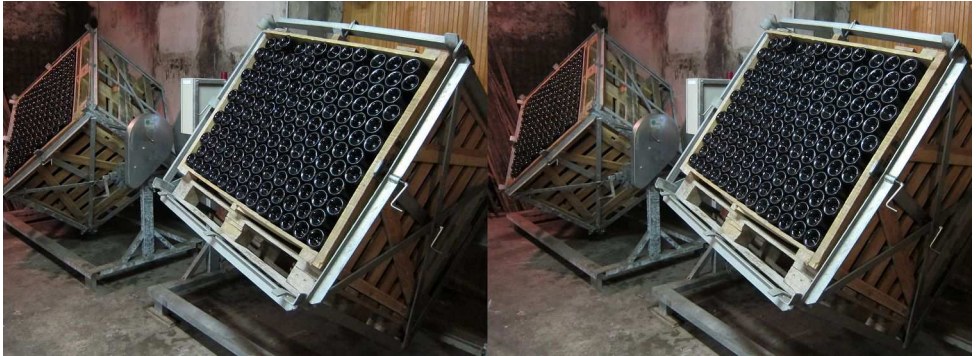
Machine à tourner les bouteilles de crémant du Jura pour rassembler les dépôts dans le goulot. Cave du Château de l'Étoile (39) - Photo : Pierre Meindre
